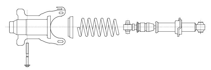
Montage von Tellern mit Fase/ Ausdrehung (falls vorhanden) Fitting of plates with chamfer (if exist)
